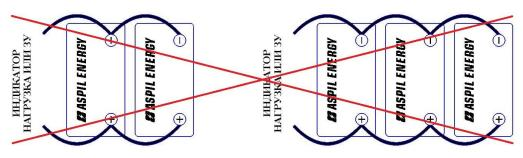
Подключение нагрузки и/или зарядного устройства к параллельной сборке из АКБ приведенным на рисунке выше способом – является неверным. Подобное подключение приводит к НЕ равномерному распределению нагрузки на АКБ.
