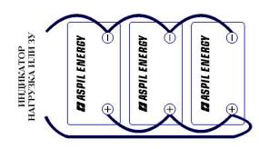
Подключение нагрузки и/или зарядного устройства к параллельной сборке из АКБ приведенным на рисунке выше образом – является верным (подобное подключение приводит к более равномерному распределению нагрузки на АКБ).
