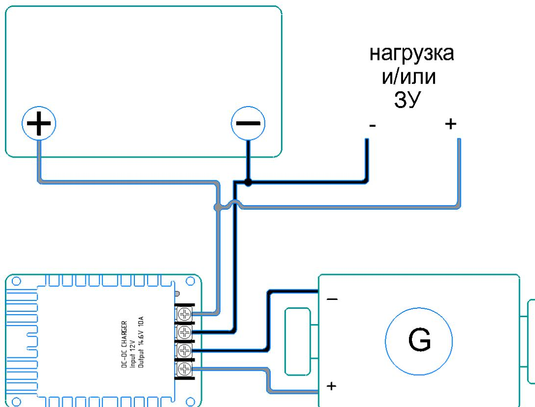
3.1 Устройство подключается в цепь питания от генератора или стартерного АКБ (Input) к АКБ которую необходимо заряжать (Output) с соблюдением полярности. Функцию ACC при необходимости возможно подключить через дополнительное реле.
